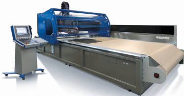
Mitfahrende Haube und Teiletransport durch Papiervorschub
