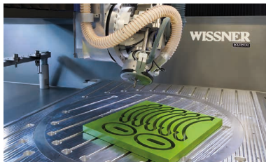
5D Bearbeitung mit Schwenkopf und Drehtischmodul
